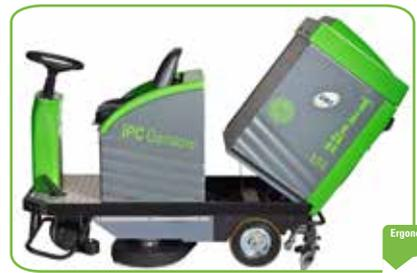
Der kippbare Tank ermöglicht den leichten
