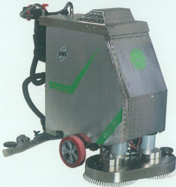
Die handgeführte Scheuersaugmaschine Premium Green Line 61 BF 68 RR. Die Kennzeichnung RR = Reinraum steht für die Einhaltung der Anforderungen der geltenden ISO Norm EN ISO 14644
