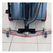
**Saugfuß aus Edelstahl** Mit Schnellwechselvorrichtung zum Wechseln der Sauglippen.
